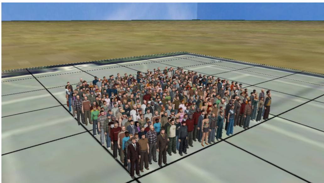
Fig. 2 – Modelação de uma multidão<sup>4</sup> com 4 pessoas por m<sup>2</sup> – Fonte: (Still, 2000)
